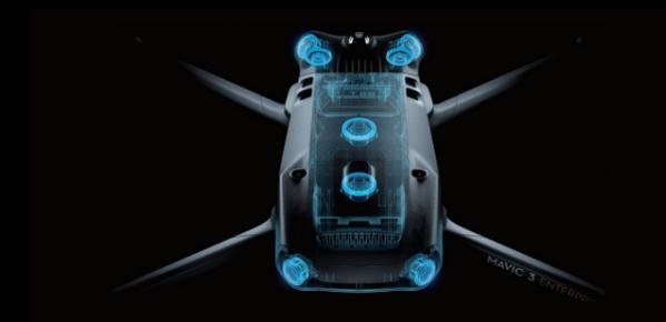
全ての側面に広角レンズを搭載し、死角のない全方向障害物検知を実現しています。ミッションごとの必要条件に合わせた形で、接近アラートや制動距離を調整できます。\*6
